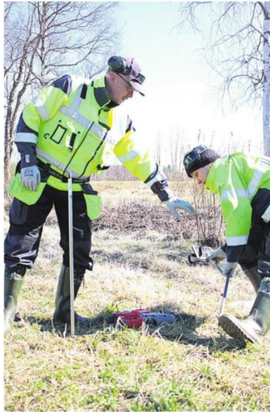
Hannu Hirvasniemi GTK:sta väki ottaa kairalla maanäytteitä noin kolmen metrin syvyydeltä. Maanäytteet analysoidaan ja pH määritetään laboratorioissa.
